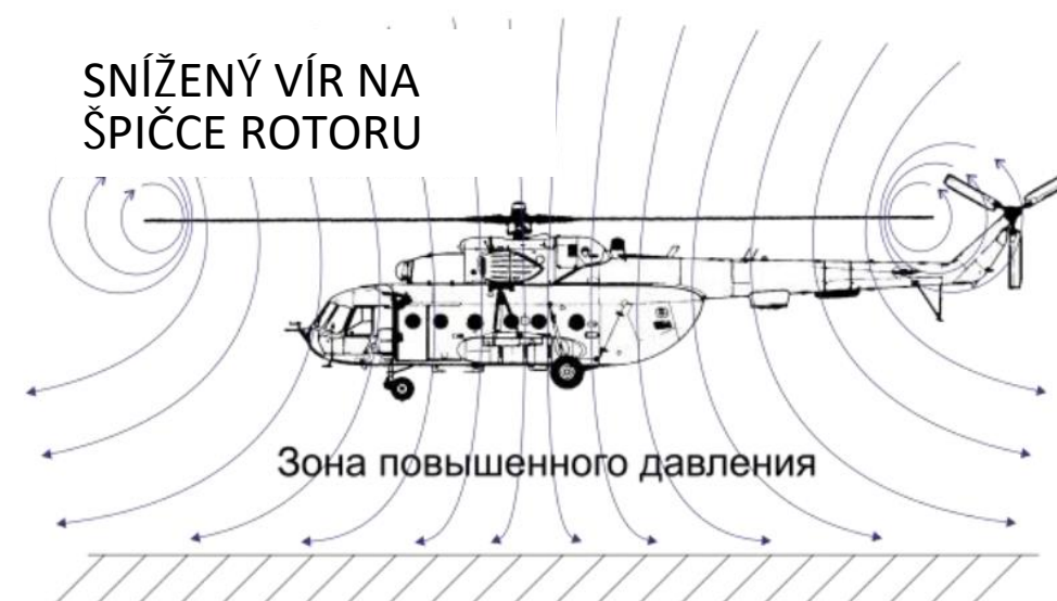
Obr. 9.17. Proudění vzduchu s přízemním efektem
